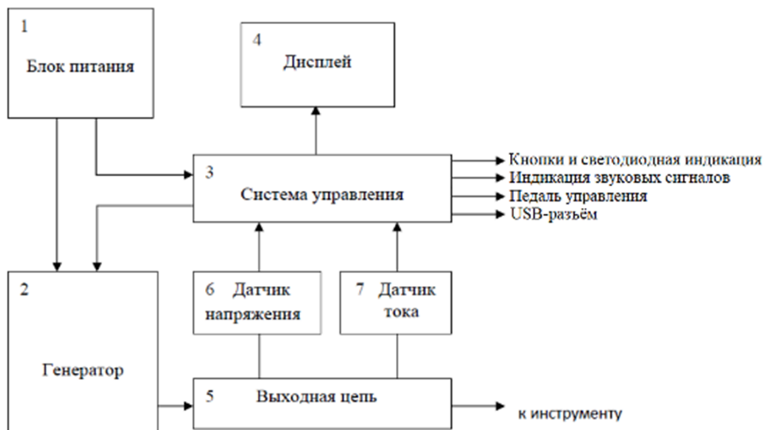
Рис. 1. Структурная схема автоматизированного комплекса радиочастотной абляции с одновременным эффектом достижения трансмуральности
