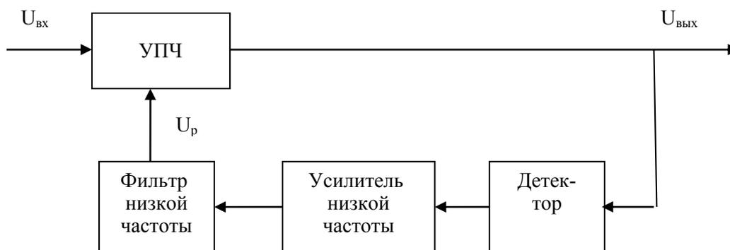
Рис. 1. Структурная схема быстродействующей регулировки усиления
