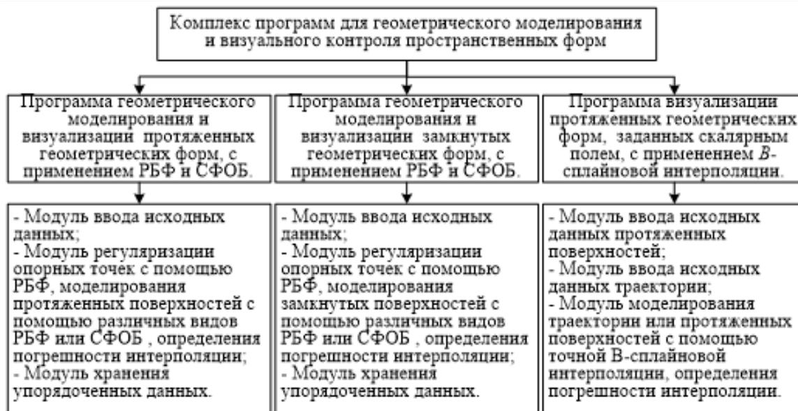
Рис. 1. Структура комплекса программ для экспериментального исследования смешивающих функций
